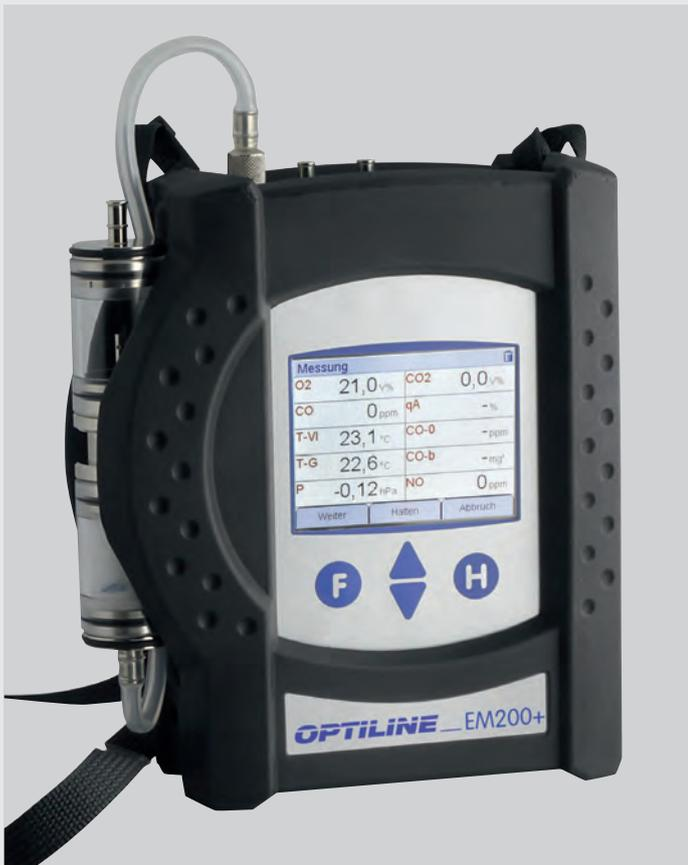
Das OPTILINE EM200+ misst zuverlässig und genau, damit Gas-, Öl- und Pelletheizungen richtig eingestellt werden. Es ist für die Praxis entwickelt und überzeugt durch Robustheit und die einfache Bedienung.
