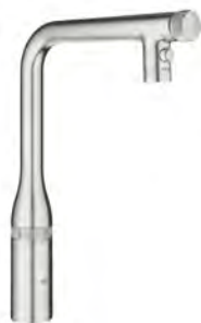
ESSENCE SmartControl-Kitchenarmatur L-Auslauf, schwenkbar, ausziehbare Brause, zweistrahlig, Ausladung 201 mm, Höhe 373 mm, SmartControl: An/Aus per Knopfdruck
