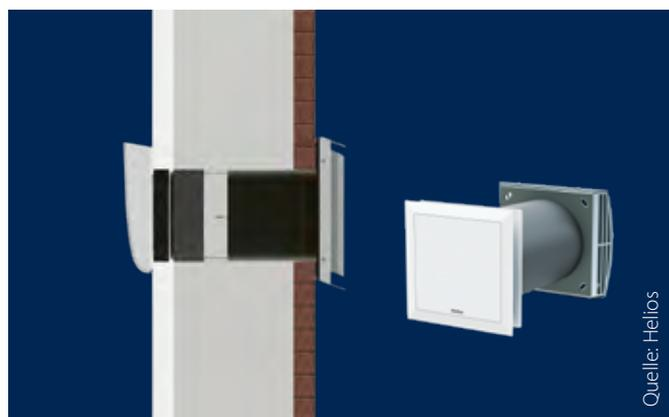
**Dezentrale Lüftungslösung** für paarweisen Betrieb – Luft wird abwechselnd zu- oder abgeführt. Dabei befindet sich ein Gerät im Zuluft-Modus, während in einem anderen Raum sein Gegenpart den Raum entlüftet. Nach einem bestimmten Zeitintervall wechseln die Luftrichtungen. Je Lüftungsgerät genügt eine einfache Kernlochbohrung durch die Außenwand. Ideal auch für die Nachrüstung.
