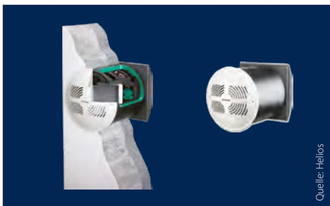
**Zwei dezentrale Ventilatoren** und ein rekuperativer Wärmetauscher – ohne zusätzliche Verrohrung. Hier ist eine entsprechende Anzahl von Geräten für die benötigte Luftmenge einzubauen. Zusätzlich sollte ein feuchtegeführter Abluftventilator in den feuchtebelasteten Räumen verbaut werden.
