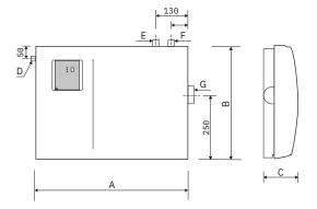
A: 590 mm B: 450 mm C: 260 mm D: Trinkwasser ¾"-AG E: Saugstutzen 1"-AG
