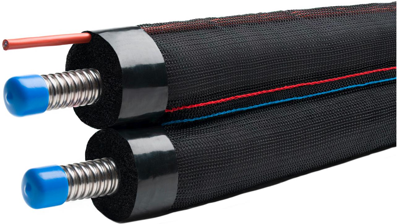
Flexibles Doppelrohrsystem für die Anwendung im Solarthermie-Bereich. Das Doppelrohr ist in der Mitte trennbar durch abgenähte Einzelleitungen. Das Edelstahlwellrohr ist gedämmt mit temperaturbeständiger, FCKW-freier EPDM-Kautschukdämmung. Das Schutzgarn, gewebt aus Monofilament, ist engmaschig, flexibel, extrem reißfest und UV-beständig.
