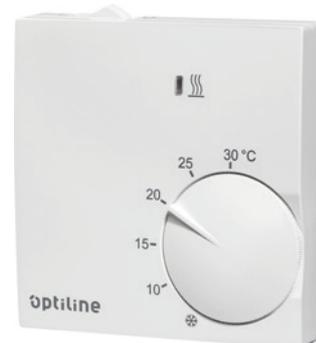
Raumregler extra flach für Wandbefestigung. Eignet sich für die Regelung von Zentral-, Warmwasserfußboden-, Elektro-, Nachtspeicherheizungen usw. 1 Schalter Netz, 1 Kontrollleuchte: Heizen, Bimetall-Technik mit thermischer Rückführung und hoher Präzision. Aufputzmontage oder direkt auf UP-Dose mit waage-/senkrechten Befestigungslöchern oder mit Schnappbefestigung auf DIN-Schiene.
