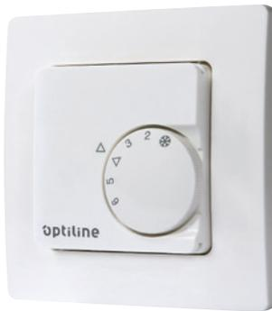
Universell einsetzbarer Unterputz-Regler, geeignet für viele Heizungsarten wie z. B. Öl-, Gas-, Warmwasserfußboden-, Elektroheizung sowie zur Steuerung von Stellantrieben. Ausgang für Heizen. Temperaturabsenkung über externe Schaltuhr möglich. Bimetall-Technik mit thermischer Rückführung und hoher Präzision. Bereichseinengung im Einstellknopf als Heizkostenbremse. Montage in 55er-UP-Dose.
