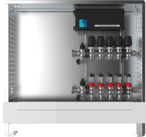
Bestehend aus FBH-Anschlussverteiler ohne Anschlussgarnitur, mit regulierbaren Durchflussanzeigern und Thermostatventileinsätzen (M30 x 1,5), montiert im Unterputz-Verteilerschrank mit Einbautiefe 110–150 mm.
