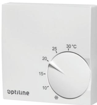
Raumregler extra flach für Wandbefestigung. Eignet sich für die Regelung von Zentral-, Warmwasserfußboden-, Elektro-, Nachtspeicherheizungen usw. Schalter Heizen/Kühlen. Bimetall-Technik mit thermischer Rückführung und hoher Präzision. Aufputzmontage oder direkt auf UP-Dose mit waage-/senkrechten Befestigungslöchern oder mit Schnappbefestigung auf DIN-Schiene. Farbe RAL 9016, weiß.
