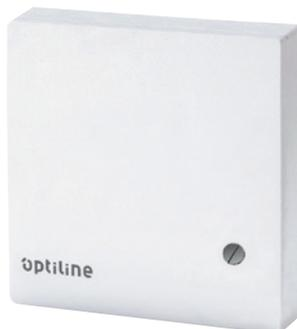
Die Einstellung der Raumtemperatur erfolgt unter dem Gehäusedeckel und ist somit geschützt gegen unbefugtes Verstellen. Bimetall-Technik mit thermischer Rückführung und hoher Präzision. Temperaturabsenkung über externe Schaltuhr möglich. Aufputzmontage oder direkt auf UP-Dose mit senkrechten Befestigungslöchern oder mit Schnappbefestigung auf DIN-Schiene.
