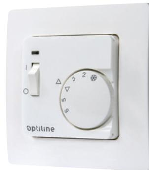
Universell einsetzbarer Unterputz-Regler, geeignet für viele Heizungsarten wie z. B. Öl-, Gas-, Warmwasserfußboden-, Elektroheizung sowie zur Steuerung von Stellantrieben. Ausgang für Heizen. Schalter Netz: Ein/Aus; Netz: Ein. Temperaturabsenkung über externe Schaltuhr möglich. Bimetall-Technik mit thermischer Rückführung und hoher Präzision. Bereichseinengung im Einstellknopf als Heizkostenbremse. Montage in 55er-UP-Dose.
