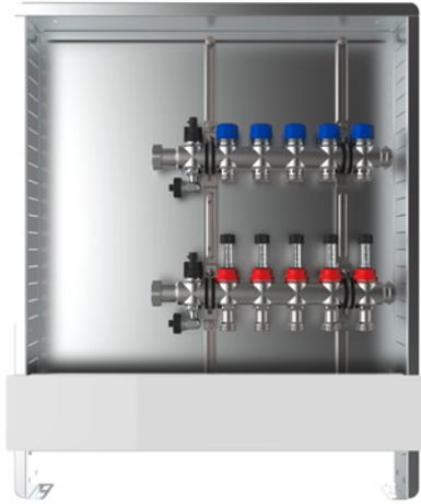
Bestehend aus FBH-Anschlussverteiler, mit regulierbaren Durchflussanzeigern und Thermostatventileinsätzen (M30 x 1,5), ohne Anschlussgarnitur, montiert im Unterputz-Verteilerschrank mit Einbautiefe 110–150 mm.
