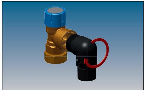
⇒ Montieren Sie das Membran-Sicherheitsventil (MSV) Typ Prescor B 3/4 (Ausführung in 6, 8 oder 10 bar) mit der mitgelieferten Anschlussverschraubung R 3/4 x G 1 auf der Sicherheitsstrecke.
