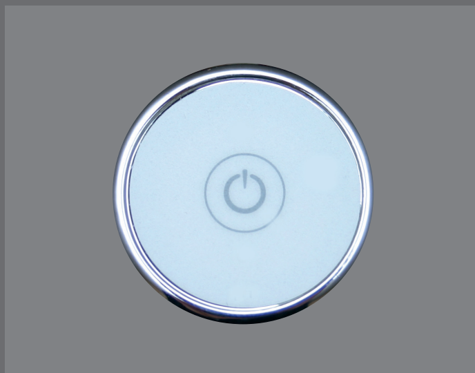
1 x Tippen – Farblichtwechsler ein, 1 x Tippen – FLW hält an 1 x Tippen – FLW läuft weiter, 3 sec. halten – FLW aus
